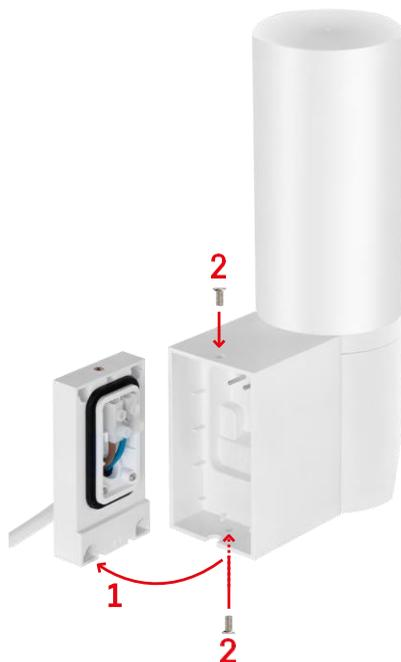
Installare l'unità della telecamera sulla staffa (staffa di installazione). Avvitare l'unità della telecamera con le viti.
